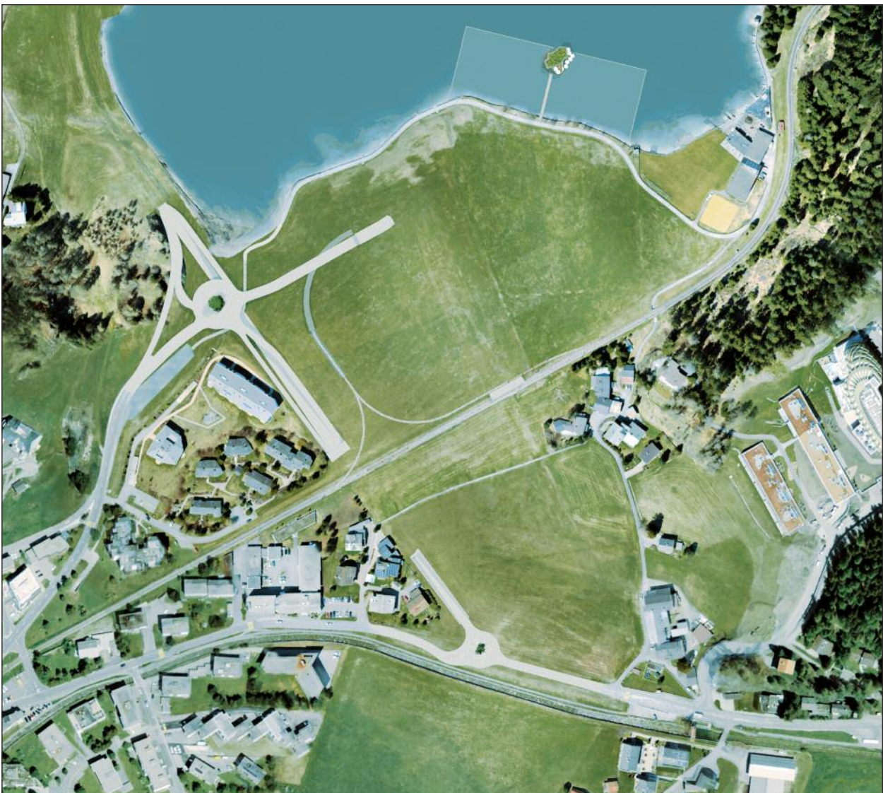
Kreisel für Flüelabypass und Einfahrt ins Parkhaus «im See». Das Bündaquarter wird von Norden her neu erschlossen.
